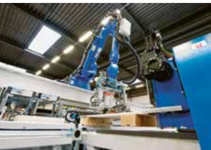
Der Roboterarm nagelt die Kisten- teile in Rekordzeit zusammen.
